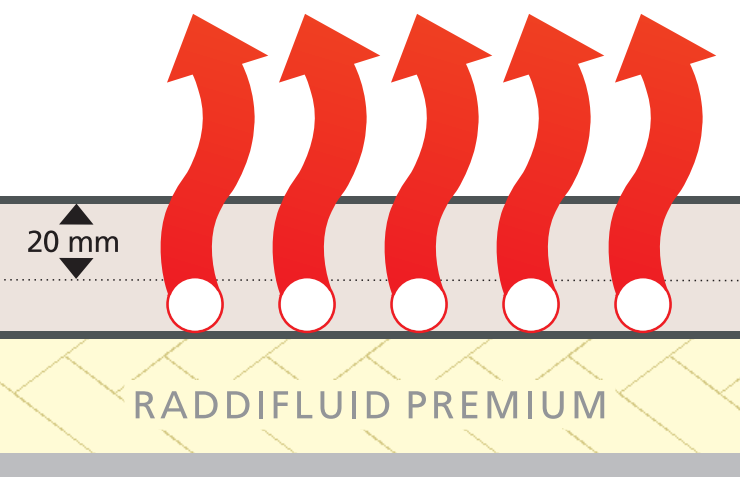
Chape avec 2 cm au-dessus des tuyaux
