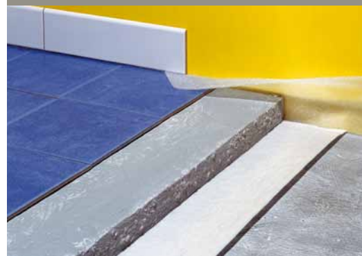
Exemple de pose de Tramichape® associé au Tramiplinthe® pour assurer la désolidarisation de la chape.
